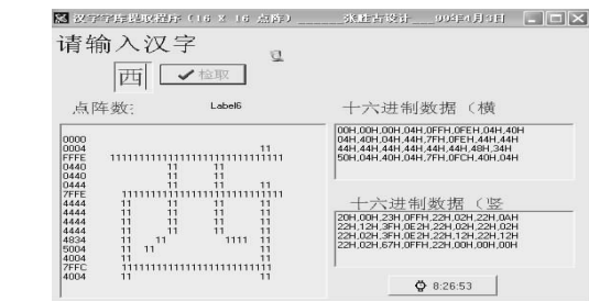
图 3 汉字字模点阵数据批量生成软件 Fig. 3 Chinese characters mold lattice generated software
